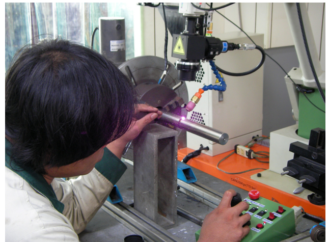
圖4. 軸型工件--高速旋轉軸心磨損缺陷修補
