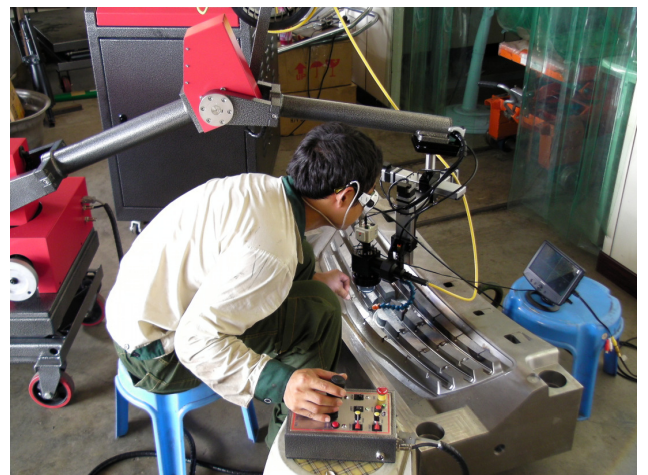
圖 2. 中型模具--汽車前欄模具現場雷射焊補
