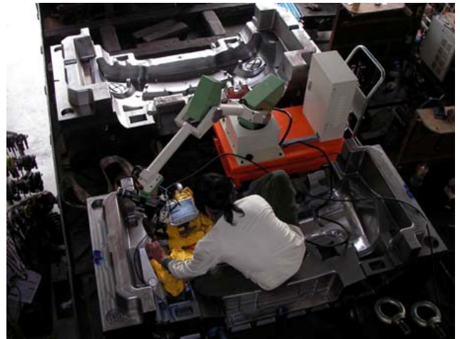
圖 1. 超大型模具--汽車保險桿模具現場雷射焊補
