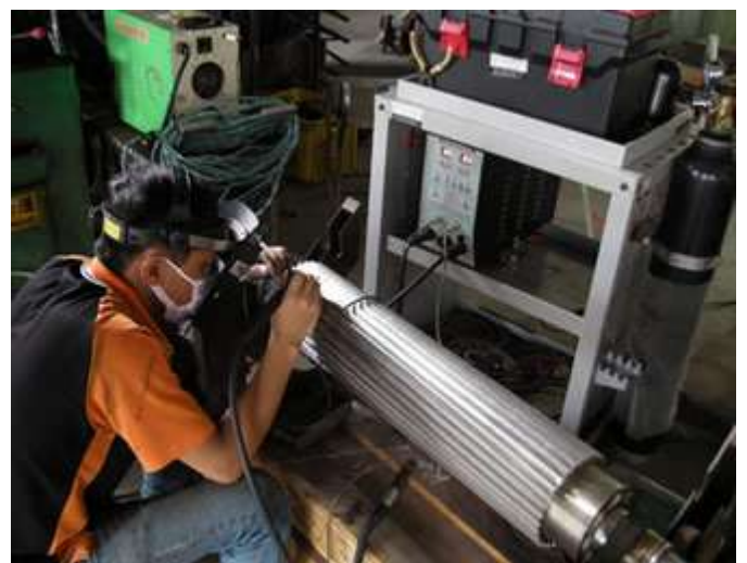
圖6. 冷焊刀模崩角 STELLITE12 焊補。
