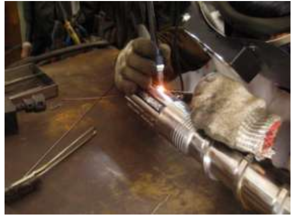
圖1. 以冷焊修補氮化處理螺桿為氮化層焊補造生氣孔較少之方式之一。
