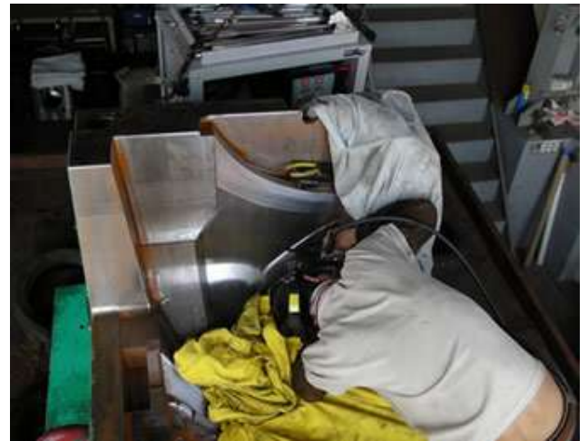
圖5. 大型汽車保險桿模具(P-3 材質)模面冷焊後咬花處理，冷焊補可達最佳效果！
