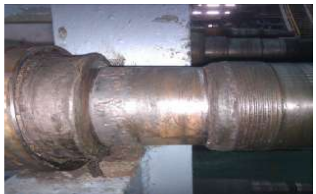
圖3. 導電銅輓軸承位磨損之低入熱量式修補，不可造成軸心變形過大為主要訴求。
